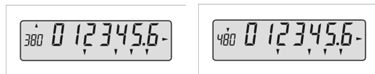
Zobrazenie jalovej energie +R a jalovej energie -R, formát 6 + 1
