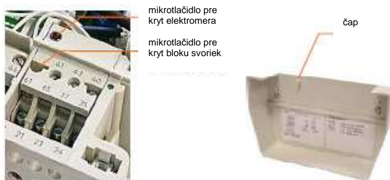
Obrázok 51: mikrotlačidlo v kryte bloku svoriek
